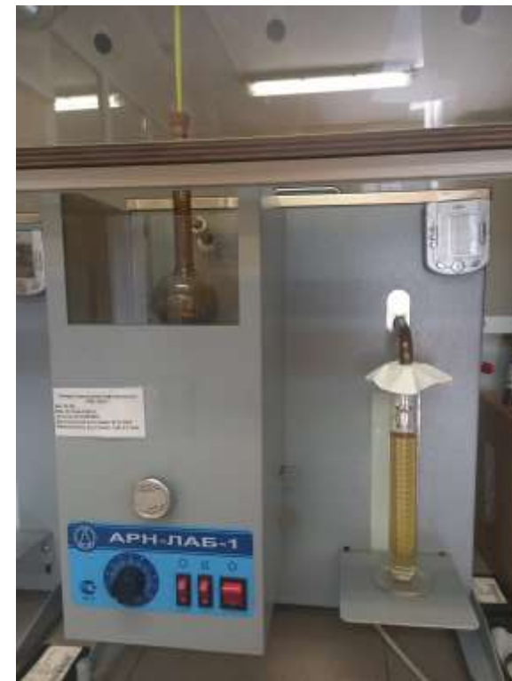
Аппарат для определения фракционного состава
