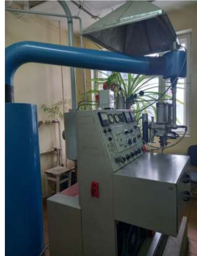
Аппарат для определения октанового числа
