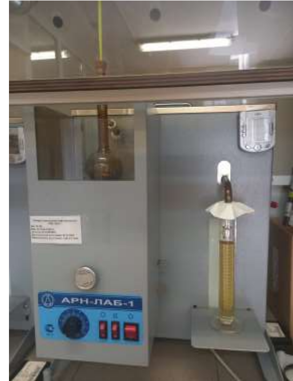
Аппарат для определения фракционного состава
