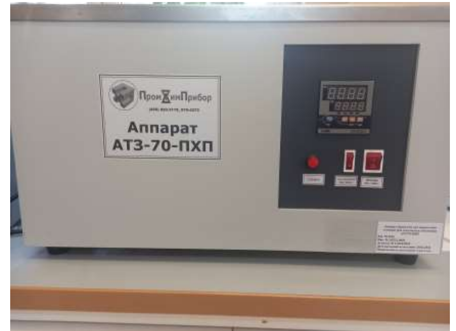
Аппарат для определения предельной температуры фильтруемости на холодном фильтре
