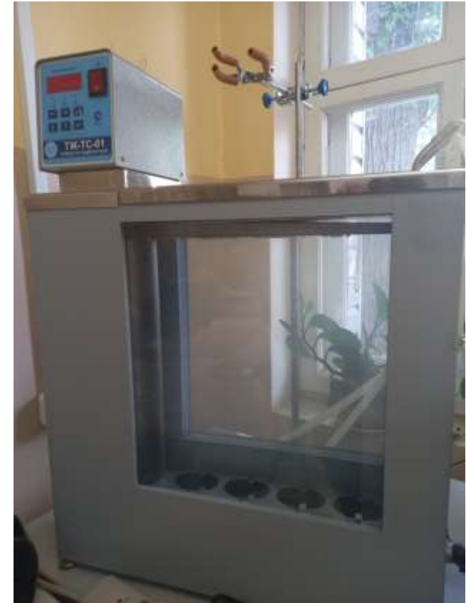
Аппарат для определения плотности
