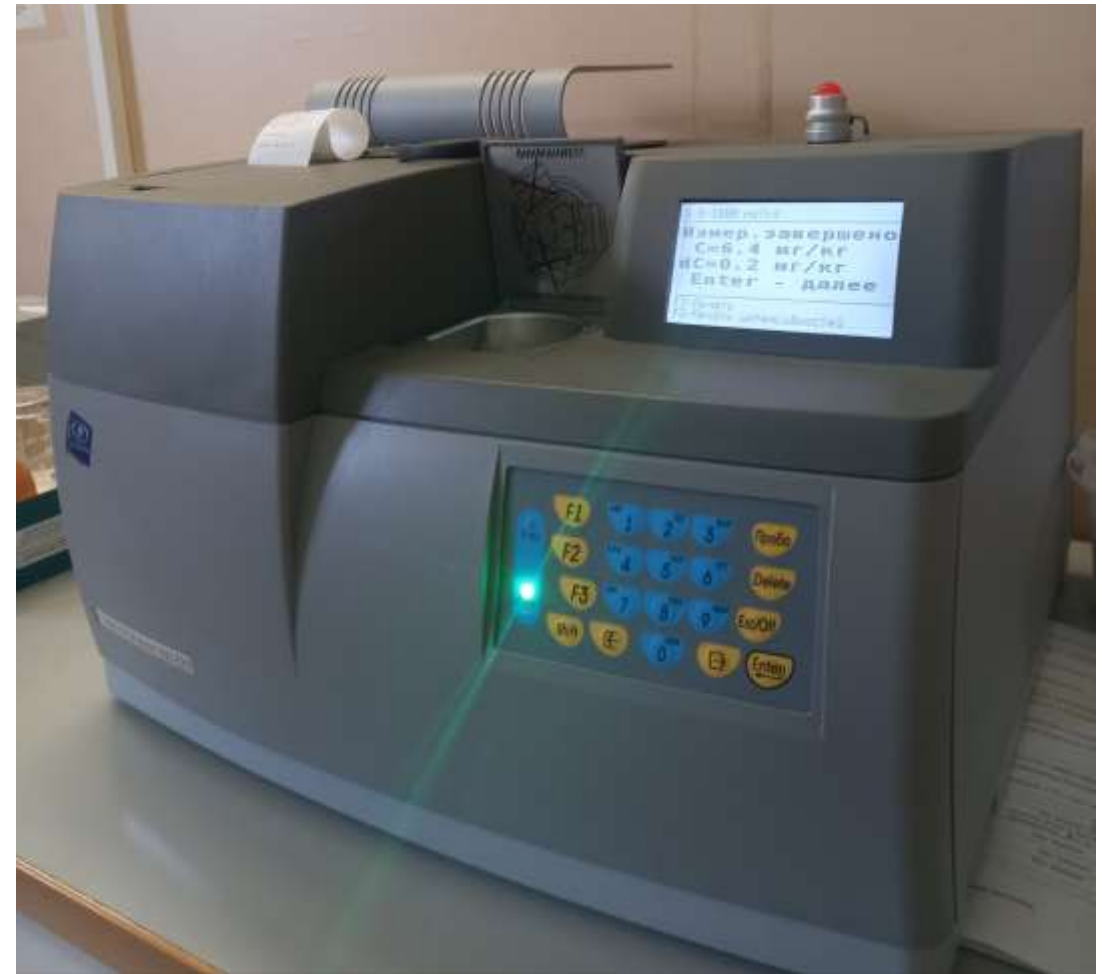
Спектроскан SW-D3 для определения содержания серы
